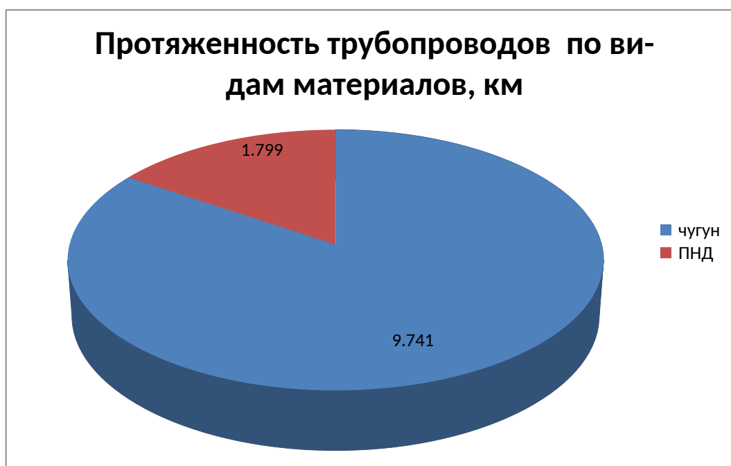
Рисунок 6.4.4.2. Длина трубопроводов МУП «Шарьинская ТЭЦ» по материалу изготовления.
